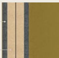
2 panneaux de particules forte densité épaisseur 10 mm, 2 épaisseurs de mousse de Mélamine 5 mm collées de chaque côté, soit 10 mm. Le tout recouvert de Tissu.
